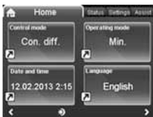
Рис. 12 Пример главного дисплея насоса TPE серии 2000 с улучшенной панелью управления
